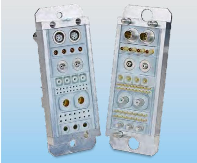
Der Alu-S Rahmen besteht aus 2 Endstücken und 2 Schienen mit Führungs- und Befestigungselementen. Dabei wird beim ODU-MAC S Rahmen das Buchsenteil fest und das Stiftteil schwimmend eingebaut. Dieses System ist für 3 bis 60 Rastereinheiten ausgelegt, d.h. bei Einsatz des 10-poligen Moduls können 600 Kontakte eingebaut werden.
