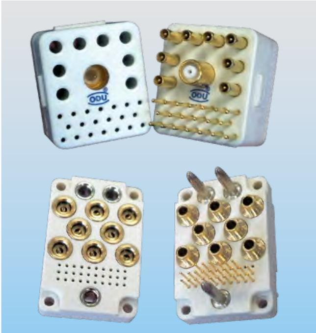
Einteilige Isolierkörper bestückt mit Standard ODU-MAC Kontakten. Kunden bauen diesen Isolierkörperblock in ein eigenes Gehäuse ein.
