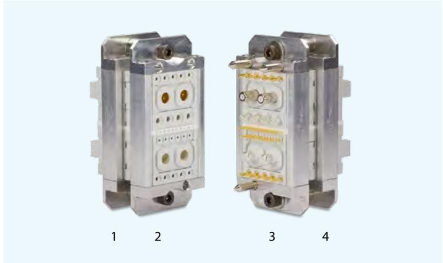
Bei Verschleiß der Kontakte werden die beiden Wechselteile 2 und 3 von Teil 1 und Teil 4 abgezogen und können schnell und problemlos durch die neuen Wechselteile ohne Konfektionsaufwand ersetzt werden.
